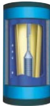
Aprovechamiento de calor doble Acumulador Logalux PL...S
